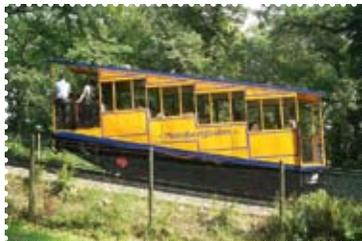
Die Nerobergbahn ist eine 1888 errichtete Wasserlast- und Zahnstangen-Standseilbahn im Norden Wiesbadens. Sie überwindet dabei auf einer Länge von 438 m und bei einer Steigung von 19 % einen Höhenunterschied von 83 m. Als letzte Bergbahn dieses Typs in Deutschland ist sie technisches Kulturdenkmal.
